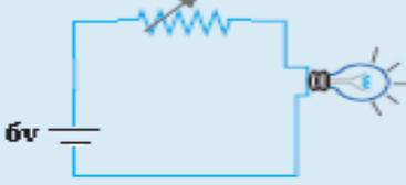
أوصل الدارة المجرورة باستخدام بطارية 6V ، مصباح ومقاومة متغيرة ، أبدأ بتحريك ذراع المقاومة المتغيرة ، ولاحظ شدة إضاءة المصباح مع زيادة قيمة المقاومة في الدارة ؟ عند عكس اتجاه حركة الثراع تقل المقاومة ، فسر ذلك؟
